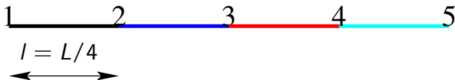
$$\begin{bmatrix} f_{12} \\ f_{21} \end{bmatrix} = \frac{ES}{l} \begin{bmatrix} 1 & -1 \\ -1 & 1 \end{bmatrix} \begin{bmatrix} 0 \\ u_2 \end{bmatrix}, \quad \begin{bmatrix} f_{23} \\ f_{32} \end{bmatrix} = \frac{ES}{l} \begin{bmatrix} 1 & -1 \\ -1 & 1 \end{bmatrix} \begin{bmatrix} u_2 \\ u_3 \end{bmatrix}$$
