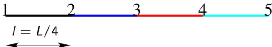
$$\begin{bmatrix} f_{12} \\ f_{21} \\ f_{34} \\ f_{43} \end{bmatrix} = \frac{ES}{l} \begin{bmatrix} 1 & -1 \\ -1 & 1 \\ 1 & -1 \\ -1 & 1 \end{bmatrix} \begin{bmatrix} 0 \\ u_2 \\ u_3 \\ u_4 \end{bmatrix}, \quad \begin{bmatrix} f_{23} \\ f_{32} \\ f_{45} \\ F \end{bmatrix} = \frac{ES}{l} \begin{bmatrix} 1 & -1 \\ -1 & 1 \\ 1 & -1 \\ -1 & 1 \end{bmatrix} \begin{bmatrix} u_2 \\ u_3 \\ u_4 \\ u_5 \end{bmatrix}$$
